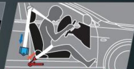
2-WAY PRETENSIONER WITH FORCE LIMITER FRONT SEATBELTS (DRIVER SIDE) เข็มขัดนิรภัยด้านคนขับแบบดึงกลับ และผ่อนแรงอัตโนมัติ แบบ 2 ทิศทาง
