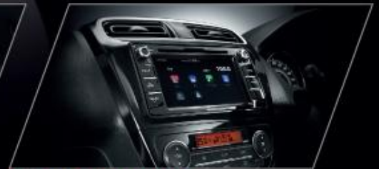
ENTERTAINMENT SYSTEM ระบบเครื่องเสียง 2 DIN หน้าจอสัมผัส 6.5 นิ้ว พร้อมเครื่องเล่น DVD / MP3 และระบบรองรับการเชื่อมต่อสมาร์ทโฟน พร้อมรองรับ Apple CarPlay*
