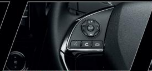
STEERING WHEEL REMOTE CONTROL SWITCH / VOICE COMMAND WITH HAND FREE SWITCH สวิตช์ควบคุมเครื่องเสียง ควบคุมการทำงานด้วยเสียง และปุ่มรับสาย-วางสาย โทรศัพทที่พวงมาลัย ใช้งานง่าย เพียงปลายนิ้ว ให้คุณควบคุมอุปกรณ์ได้ โดยไม่ต้องละมือ จากพวงมาลัย และสายตาจากถนน
