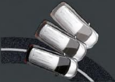
ACTIVE STABILITY CONTROL (ASC) ระบบควบคุมเสถียรภาพการทรงตัว ในสภาวะที่รถเสียสมดุล เพื่อช่วยควบคุมกรณีที่เกิดการลื่นไถลออกนอกเส้นทาง เช่น กรณีหลุดโค้งเมื่อเข้าโค้งด้วยความเร็วสูง ถนนลื่น หรือหักหลบกะทันหัน
